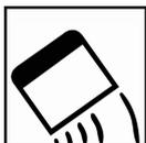
Aplicar o betume de polyester ao substrato utilizando uma espátula num ângulo de 60°. Evitar a acumulação de betume nas extremidades da superfície a reparar aplicando o sobranço em diminuição até ao acabamento original.
