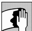
Eliminar qualquer contaminação da superfície antes de aplicar o betume utilizando o limpador/desengordurante adequado.
