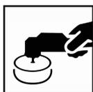
Se pode polir a poeira e as pequenas imperfeições uma vez que os tempos de secagem por ar estabelecidos se tenham cumprido; ou depois de uma secagem completa a uma temperatura do objecto de 60° C, seguido por arrefecimento até alcançar uma temperatura ambiente. Lixe cuidadosamente para eliminar todas as partículas de poeira e repare a superfície de acordo com as recomendações para o polimento.
