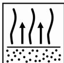
Нанесение последующего покрытия не ранее, чем через 15 минут при 20° С, но не позднее, чем через 24 час при 20° С.
