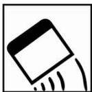
Наносите полиэфирную шпатлевку на зачищенные до металла поверхности держа шпатель под углом 60°. Сглаживайте кромки.
