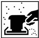
Eliminar la capa de pintura existente y lijar hasta llegar al metal utilizando P180 - P220 como fase final de lijado.
