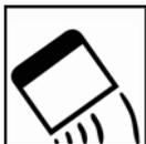
Aplicar la masilla de poliéster al sustrato utilizando una espátula en un ángulo de 60°. Evitar la acumulación de masilla en los bordes de la superficie a reparar aplicando en disminución el sobrante hacia el acabado original.
