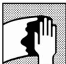
Eliminar completamente cualquier contaminación antes de iniciar el proceso de lijado con un limpiador de superficies adecuado.
