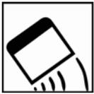
Aplicar la masilla sobre metal descubierto colocando la espátula en ángulo de 60°. Retirar los excesos de material en los contornos nivelando hasta la pintura de origen.
