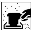
Eliminar la pintura dañada hasta usando P180 - P220 como fase final.
