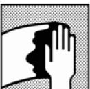
Eliminar cualquier contaminación de la superficie antes de aplicar aparejo utilizando el limpiador/desengrasante adecuado.
