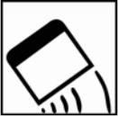
Aplicar la masilla de poliéster al substrato utilizando una espátula en un ángulo de 60°. Evitar la acumulación de masilla en los bordes de la superficie a reparar aplicando el sobrante en disminución hacia el acabado original.
