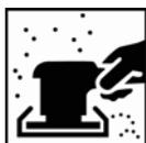
Eliminar la capa de pintura existente y lijar hasta llegar al sustrato utilizando P180 - P220 como etapa final de lijado.
