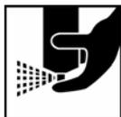
Después de la aplicación, invertir el aerosol y mantener apretada la boquilla entre 2-3 segundos. Esto permite que la boquilla quede bien limpia para su próxima utilización.
