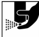
Invertir el aerosol y limpiar la boquilla después de su uso
