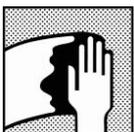
**Oberflächenreinigung:** Entfernen Sie vor dem Auftragen von 2K Plastik Primer jegliche Oberflächenverunreinigung unter Verwendung entsprechender Oberflächenreiniger, wie z.B. M700 oder Antistatik-Reiniger
