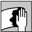
**Oberflächenreinigung:** Entfernen Sie vor dem Schleifen jegliche Oberflächenverunreinigungen unter Verwendung entsprechender Oberflächenreiniger, wie z.B. M700 oder Antistatik-Reiniger, welches spezielle Oberflächenreiniger für thermoplastische Untergründe sind.
