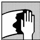
Eliminar cualquier contaminación de la superficie antes de lijar utilizando el limpiador/desengrasante adecuado.
