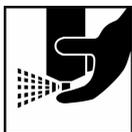
Invertir el aerosol para limpiar la boquilla después de usar
