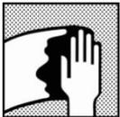
Entfernen Sie vor dem Spachtelauftrag jegliche Oberflächenverunreinigung unter Verwendung entsprechender Oberflächenreiniger.
