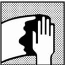
Entfernen Sie vor dem Auftragen der Grundierung / Füller jegliche Oberflächenverunreinigung unter Verwendung entsprechender Oberflächenreiniger
