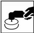
Staub und geringfügige Fehlstellen können nach einer vollen Trocknung bei 60°C Objekttemperatur, gefolgt von einer Abkühlphase auf Umgebungstemperatur, auspoliert werden. Staubeinschlüsse vorsichtig ausschleifen und die Oberfläche gemäß den Polierempfehlungen wiederherstellen.
