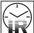
Vor der Infrarottrocknung einer Ablüftzeit von 5 Minuten gewähren.
