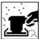
Acabamentos existentes: desengratar e lixar com P320/P400 ou processo úmido com P400/P600.
