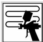
Aplicar duas a três demãos simples com flash-off de 5 - 10 minutos entre as demãos.
