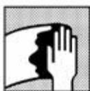
Limpeza da superfície: remover previamente qualquer contaminação da superfície antes de lixar utilizando o desengraxante adequado. Limpar previamente a superfície com água morna e detergente, em seguida enxaguar com água limpa.
