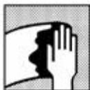
Limpeza da superfície: remover qualquer contaminação da superfície antes de aplicar o Primer Classic. Utilizar desengraxante adequado.
