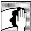
Nettoyer la surface en utilisant M700 ou Anti Static Degreaser.
