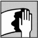
Nettoyer la surface avant ponçage en utilisant le nettoyant approprié.
