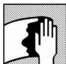
Nettoyer la surface avant application de Washprimer 1K CF en utilisant le nettoyant approprié.
