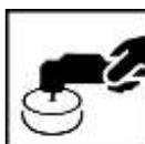
Lustrer la zone de raccord à la main ou à la machine en utilisant une pâte à polir de finition. Utiliser un grain plus gros si nécessaire.
