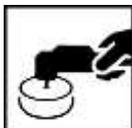
Polir soigneusement la totalité de la surface à raccorder de préférence avec une lustreuse.
