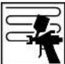
Appliquer une couche pleine sur la zone de raccord en dépassant légèrement sur la surface poncée.
