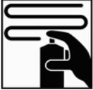
Mantener el aerosol a una distancia aproximada de 12-18 cm de la chapa y aplicar 2-3 capas uniformes.
