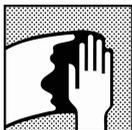
Eliminar cualquier contaminación de la superficie antes de aplicar la masilla utilizando el limpiador/desengrasante adecuado.
