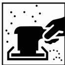
Eliminar la capa de pintura existente y lijar hasta llegar al sustrato utilizando P180 - P220 como paso final de lijado.
