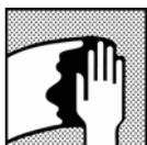
Limpieza de la superficie; retirar la contaminación utilizando M700, Anti Static Degreaser o M850. Cuando la masilla esté expuesta, evitar el contacto con el agua ( p.ej: desengrasante de base al agua).
