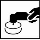
Se pueden pulir las pequeñas imperfecciones y las motas de polvo una vez que los tiempos de secado al aire o en cabina con temperatura objeto de 60°C sean completados y seguido de un enfriado hasta alcanzar una temperatura ambiente. Lije cuidadosamente para eliminar todas las partículas de polvo y repare la superficie de acuerdo con las recomendaciones para el pulido.
