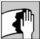
Nettoyage de la surface : avant le ponçage, nettoyer la surface avec un nettoyant de surface approprié. Utiliser M700 ou Anti Static Degreaser, qui sont des nettoyants spéciaux pour surfaces thermoplastiques. *Effectuer un nettoyage préalable de la surface à l'eau chaude et au détergent, avec une brosse dure si nécessaire, pour éliminer toutes traces d'agent de démoulage sur la surface, puis rincer abondamment à l'eau claire.*
