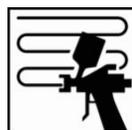
Appliquer une couche moyenne, suivie d'un temps de flash off de 3 à 5 minutes à 20°C
