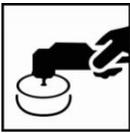
Les petites imperfections ou poussières peuvent être polies après que le temps de séchage préconisé a été respecté, ou après cuisson complète de l'objet à 60°C, suivi par un refroidissement de la pièce à température ambiante. Poncer soigneusement les particules de poussière et restaurer la surface selon les recommandations de polissage. Prêt à être poli *approximativement 1 heure après refroidissement à température ambiante.*
