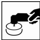
Podem-se polir as pequenas imperfeições e as poeiras uma vez que os tempos de secagem ao ar ou em cabina com temperatura objecto de 60°C sejam completos e seguido de um arrefecimento até alcançar uma temperatura ambiente. Lixe cuidadosamente para eliminar todas as partículas de poeira e repare a superfície de acordo com as recomendações para o polimento.
