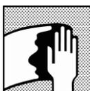
Limpeza da superfície: remover qualquer contaminação da superfície antes da aplicação do acabamento, usando um desengraxante apropriado. *Onde houver aplicação de massa, evitar contato com a água (ex: desengraxante base d'água).*
