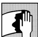
Limpeza da superfície, eliminar qualquer contaminação da superfície antes da aplicação do Autosurfacer Rapid usando desengraxante adequado.
