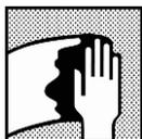
Limpeza da superfície: remover previamente qualquer contaminação da superfície antes de lixar utilizando o desengraxante adequado.
