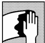
*Limpeza da superfície: remova qualquer contaminação da superfície utilizando um desengraxante apropriado.*
